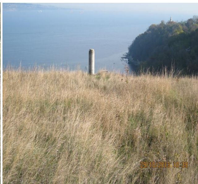
2013 г. – Опорен блок (ОБ) от реперната мрежа е на ръба на свлачищния отстъп
