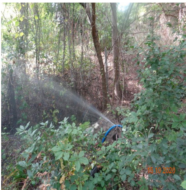
теч от маркуч и заблатяване в терена, в резултат на теча
